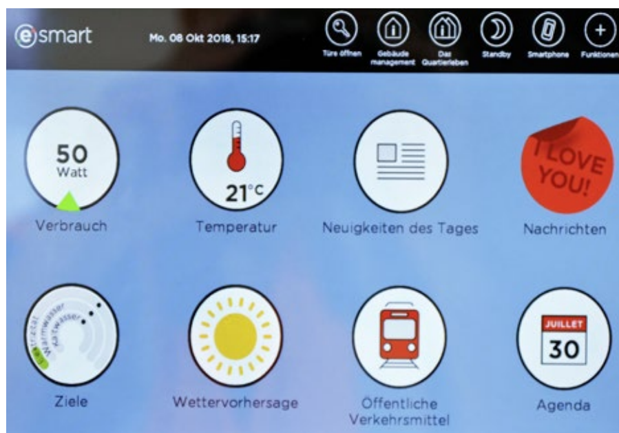
Die Benutzeroberfläche von «eSmart» basiert auf acht Schaltflächen, mit einfachen Symbolen kategorisiert, und einer Menüführung, alles über Touchscreen, aber auch Smartphone zu steuern.
