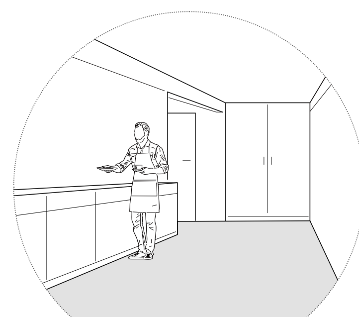
überflüssige räumliche Kombination zwischen Küchen- und Eingangsbereich
