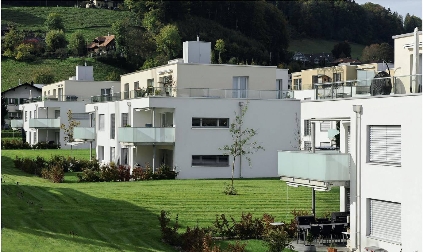
Mieter angepasst wurden. Die vierstöckigen Gebäude entsprechen einem traditionellen Massivbau und sind mit einer einfachen Aussenisolation versehen. Die Fenster bestehen aus zweifachen Isolierverglasungen. Die Flachdächer wurden mit Bitumen versiegelt und intensiv begrünt.
